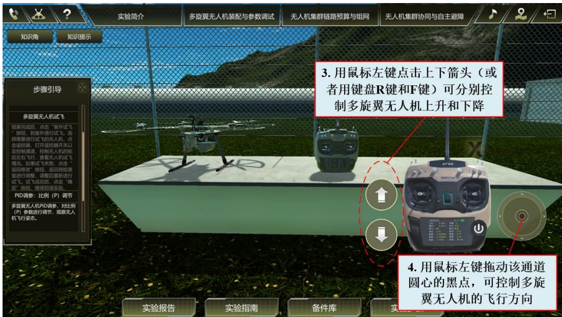
图27 使用遥控器控制多旋翼无人机飞行
