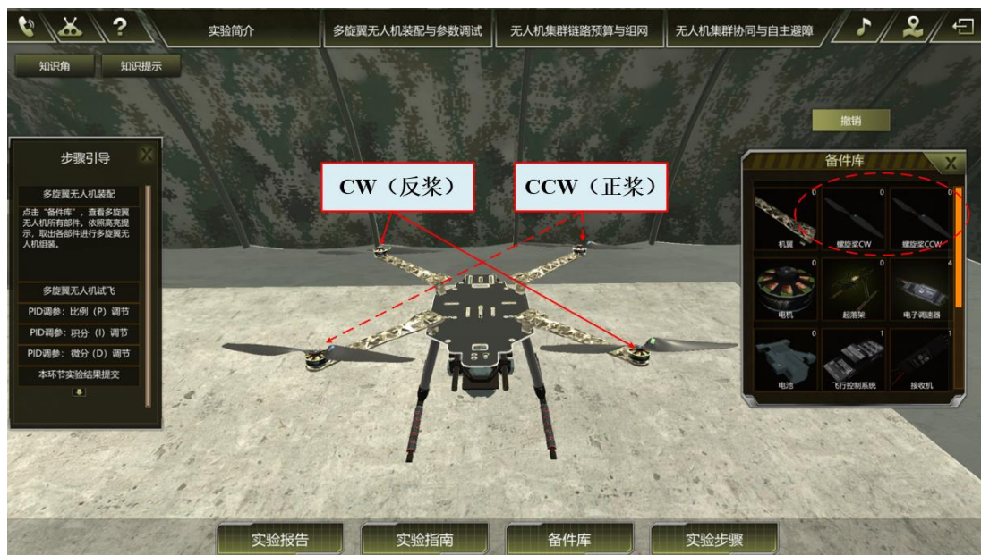
图22 正反螺旋桨的正确安装位置
