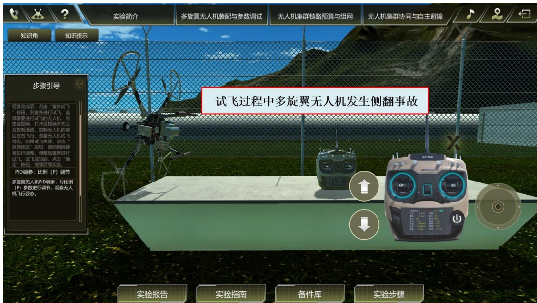
图30 正反螺旋桨安装错误导致多旋翼无人机侧翻
