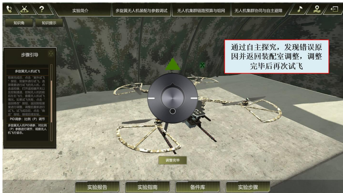
图29 返回装配室调整GPS方向
