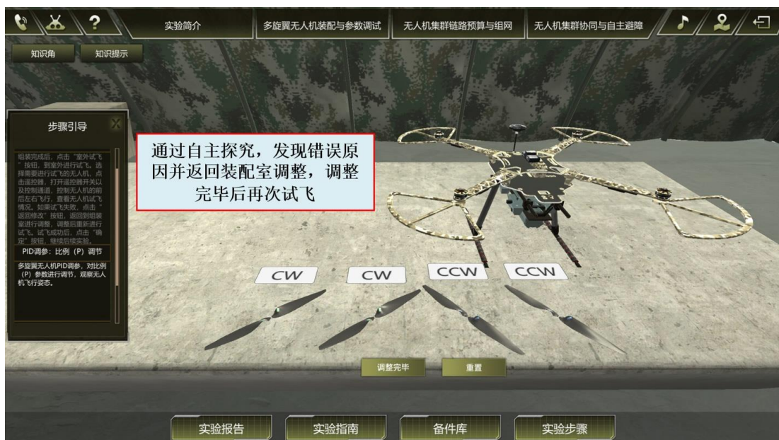
图31 返回装配室重新安装螺旋桨
