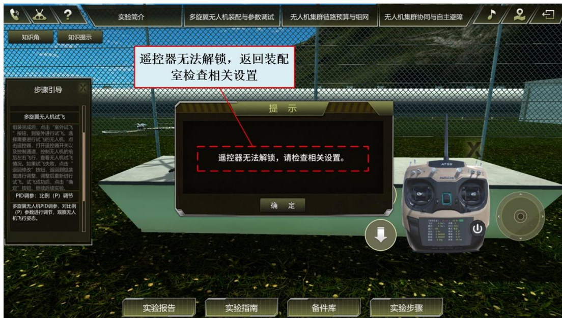
图28 GPS方向设置错误导致遥控器无法解锁
