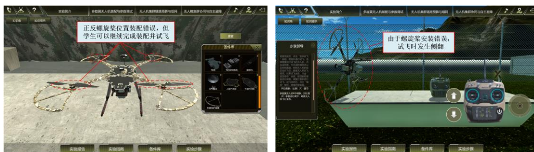
(a) 学生安装正反螺旋桨位置错误
