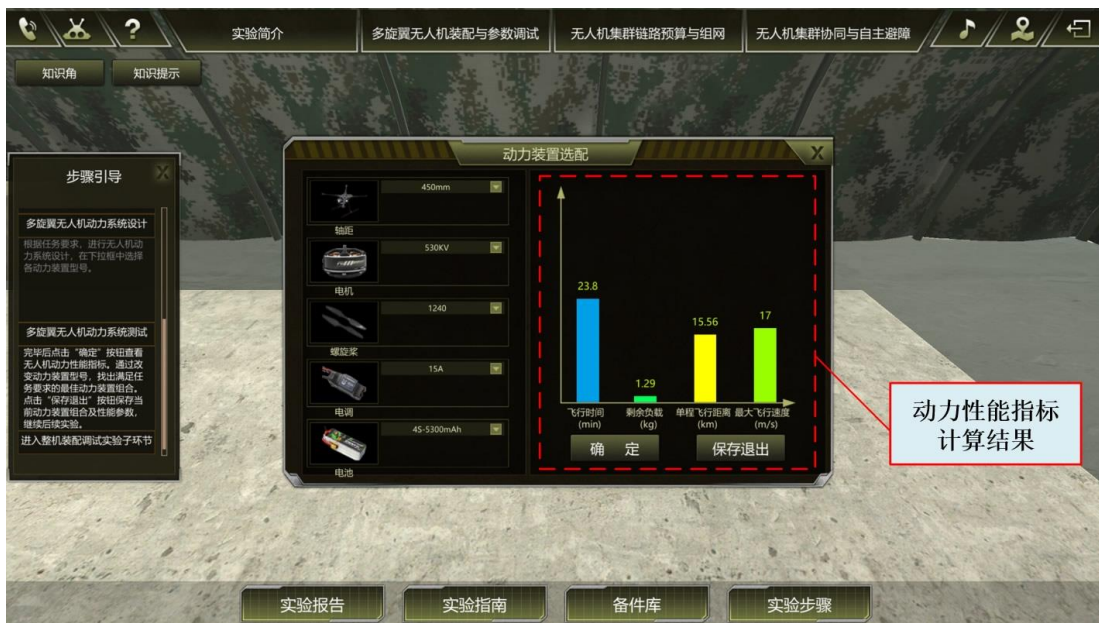
图19 系统根据学生的选择计算动力性能指标
