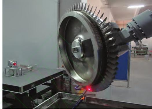
图6 整体叶盘激光冲击强化试制(空军工程大学)
