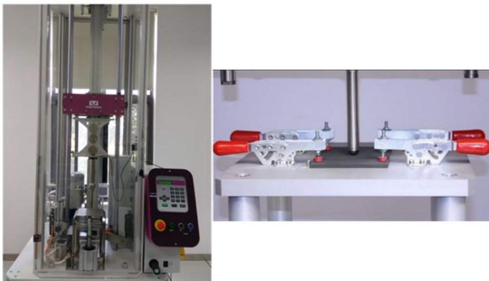
图 5.23 落锤冲击装置及示意图
