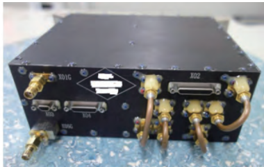
图 9 嫦娥四号着陆器 X 频段测控应答机
