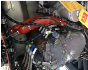
主发电机（安装在发动机附件机匣上）
