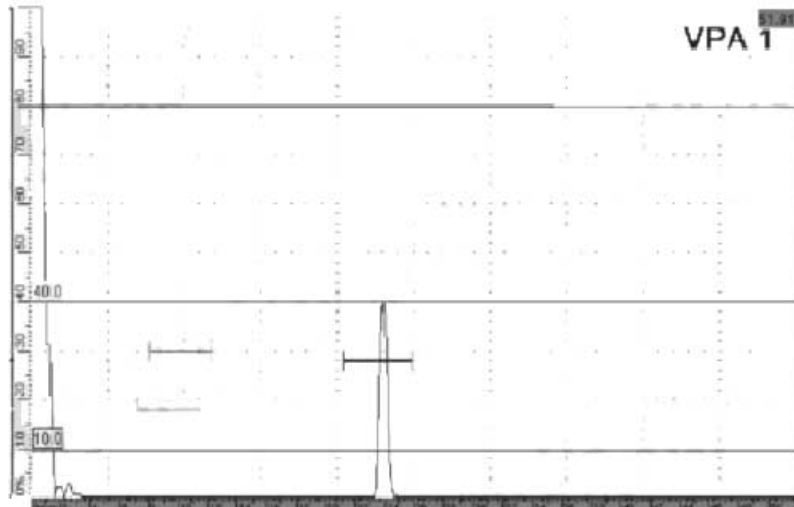
图7 相控阵检测仪通道 1 上的底波 A 扫描显示
