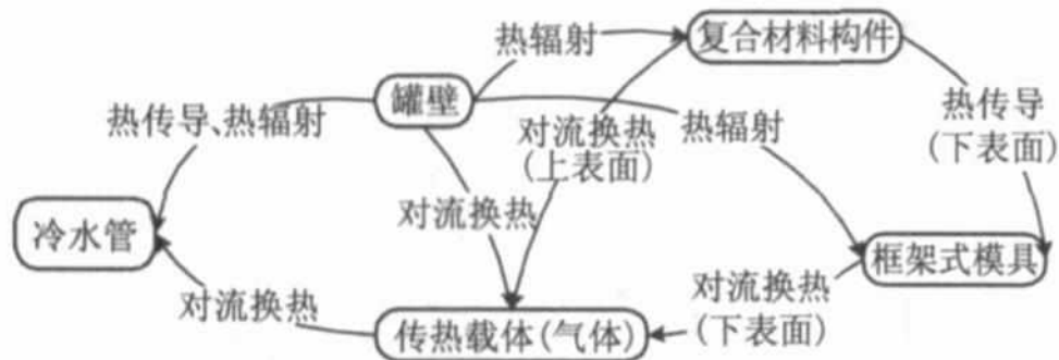
热压罐工艺成型时的传热方式和传热路径(降温)
