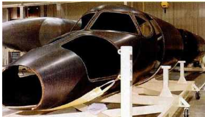
缠绕技术在航空中主要用于机身筒段的制造
