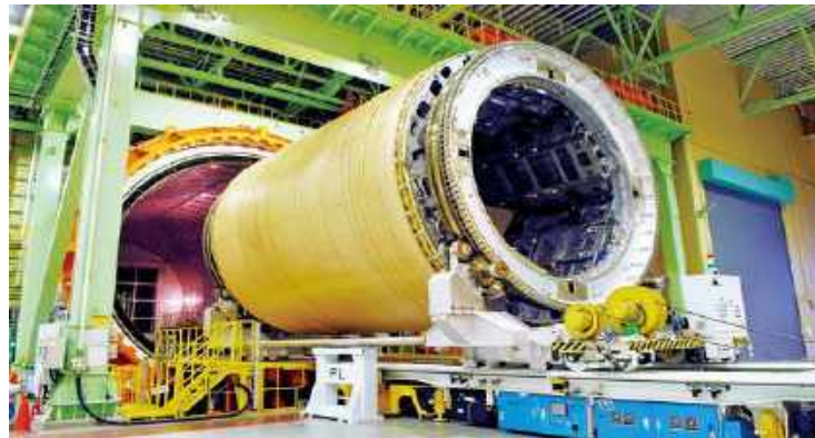
热压罐固化B787整体机身舱段
