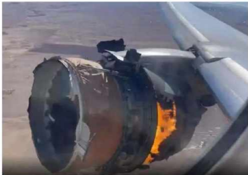
外壳碎裂并且起火燃烧的发动机
