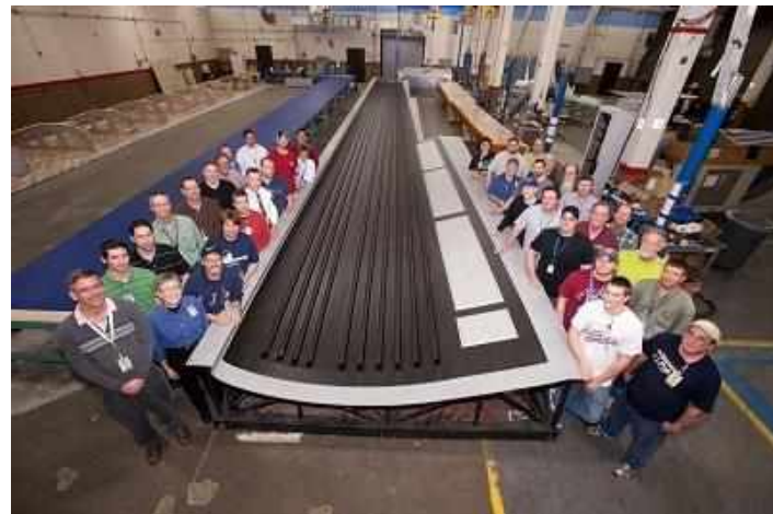
使用真空袋压工艺固化的航空大型构件
