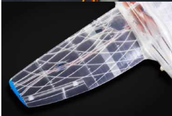
3D打印的机翼结构颠覆了传统的梁、肋、桁设计
