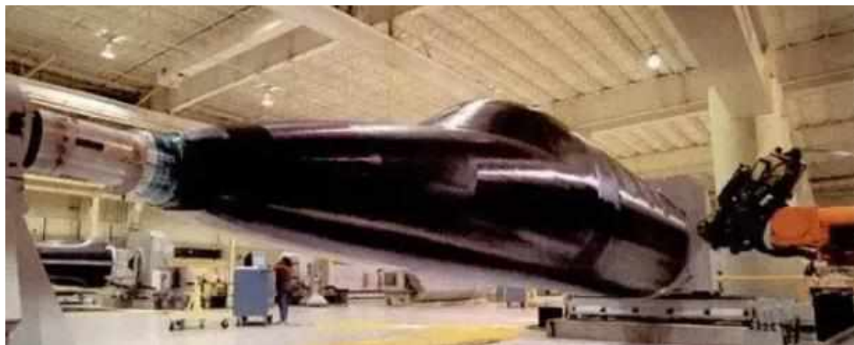
缠绕技术在航空中主要用于机身筒段的制造
