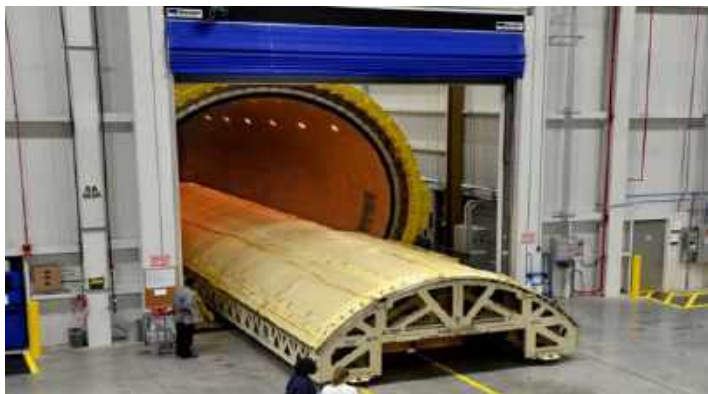
热压罐固化350XWB机身舱段
