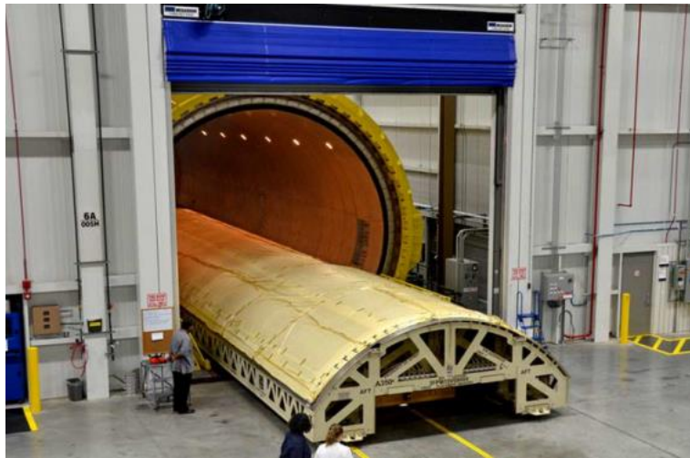
图 13 热压罐固化 350XWB 机身舱段
