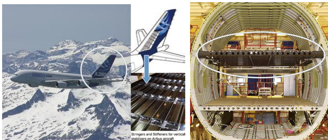
图 30 先进拉挤工艺生产的垂尾长桁和地板梁
